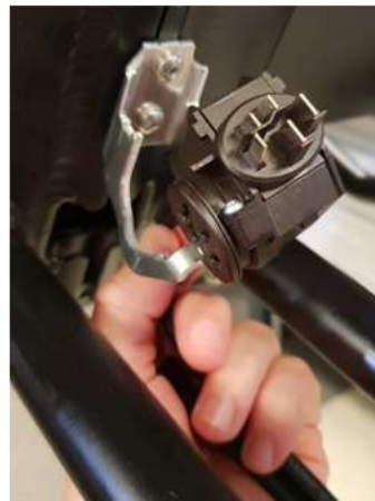
2.3 Door nu de aan de kabel bij de docking te trekken of de losgemaakte kabel wat door te duwen kan je deze kabel wat meer ruimte geven zodat je de connector uit de aluminium beugel kan drukken.
