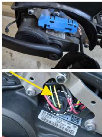
2.2 Haal daarom eerst de kap van de motor los en vervolgens de blauwe kap. Nu kan je de ovale connector losmaken bij de klikvinger met een kleine platte schroevendraaier (zie pijl).
