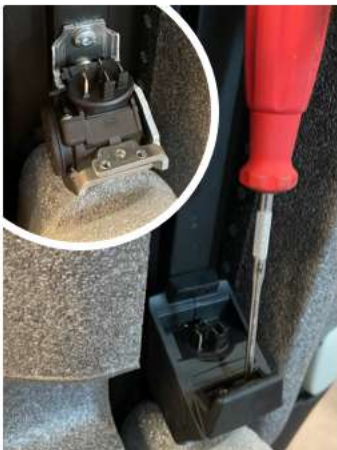
2.1 Schroef de twee delen van de behuizing los met een Torx schroevendraaier. De behuizing kan vervolgens losgehaald worden. Om de connector uit de beugel te halen moet de connectorkabel (soms) wat meer ruimte krijgen.
