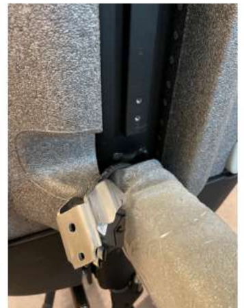
2.4 Schroef de beugel los met een Torx sleutel.
